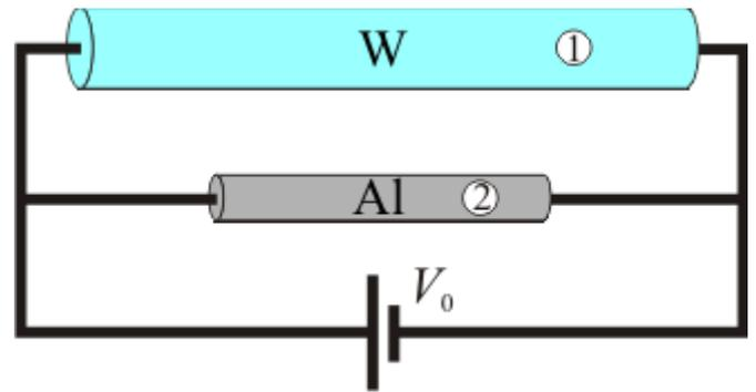
electromotriz  $V_0$  y resistencia interna despreciable, constituyendo una asociación de resistencias *en paralelo*. Sabiendo que la conductividad eléctrica del aluminio es prácticamente el doble que la del tungsteno, determine las relaciones entre las siguientes magnitudes:
